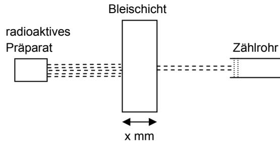
Die von der Strahlungsquelle ausgehende Gammastrahlung (energiereiche Photonen) trifft auf eine Bleischicht, deren Dicke schrittweise verändert wird. Mit einem Zählrohr wird jeweils die Anzahl derjenigen Photonen festgestellt, die die Bleischicht durchdringen. Ohne Bleiabschirmung werden pro Sekunde 149 Photonen aus dem Präparat gezählt. Die Tabelle gibt einige der Messwerte an ( $x$ : Maßzahl der Schichtdicke in mm;  $Z$ : Anzahl der Photonen pro Sekunde).
